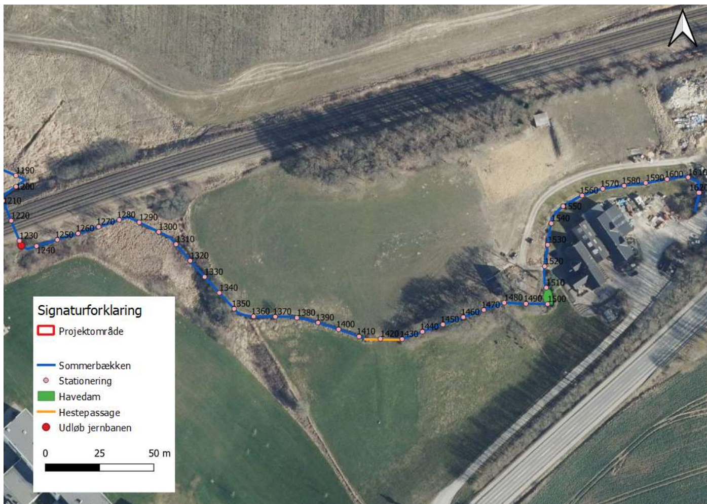
Figur 3: Oversigtskort over det eksisterende vandløb indenfor projektområdet. Angivne stationsnumre er afstand fra vandløbets begyndelse ved E45. Orto: 2021/7/
