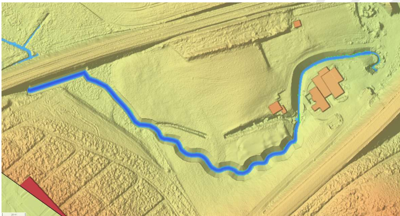
Figur 9: Simulering i SCALGO af hvorledes en vandføring på 759 l/s fordeler sig i det nye vandløbstrace med øgede dimensioner /10/
